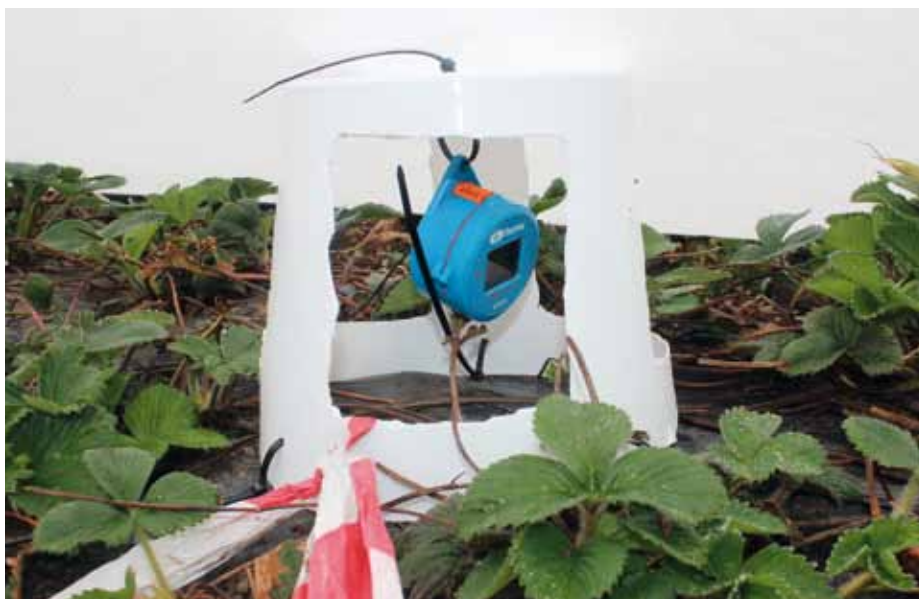
DATALOGGER – Dataloggeren blev lagt ud i marken den 4. februar 2014 under fiberduk. Den registrerer temperatur og relativ luftfugtighed én gang i timen. Derefter kan data vises på graf eller i tabel. Dette billede er fra den 19. marts.
