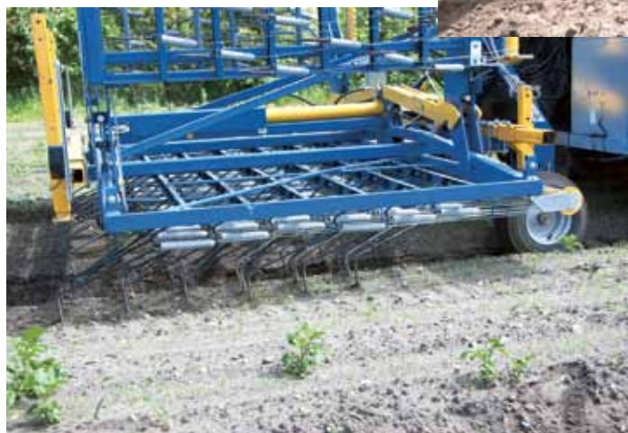
← TS 620 Treffler præcisionsharven set fra siden, hvor man tydeligt kan se de specielle dobbeltfjedre. Det var økologikonsulent Christoffel den Herder, DLV Plant i Holland, og Hermann Leggedör, Agri-Kultur, som præsenterede harven, som blev vist frem for første gang i Danmark.
