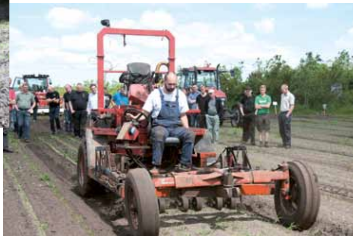
← TS 620 Treffler præcisionsharven set fra siden, hvor man tydeligt kan se de specielle dobbeltfjedre. Det var økologikonsulent Christoffel den Herder, DLV Plant i Holland, og Hermann Leggedör, Agri-Kultur, som præsenterede harven, som blev vist frem for første gang i Danmark.
