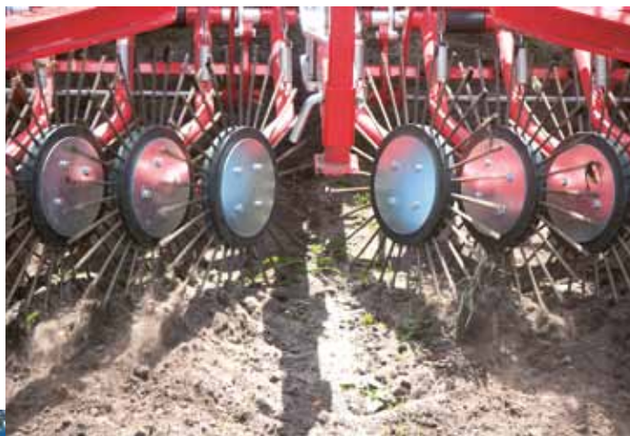
← TS 620 Treffler præcisionsharven set fra siden, hvor man tydeligt kan se de specielle dobbeltfjedre. Det var økologikonsulent Christoffel den Herder, DLV Plant i Holland, og Hermann Leggedör, Agri-Kultur, som præsenterede harven, som blev vist frem for første gang i Danmark.
